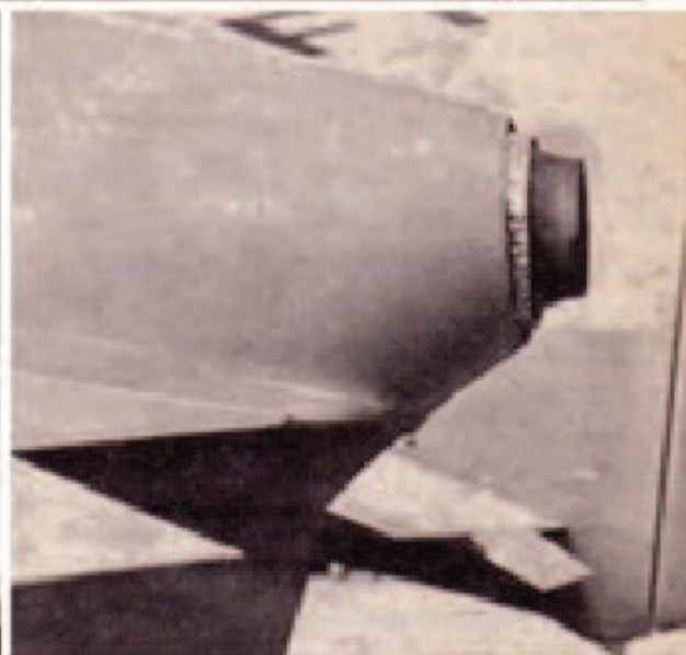
L'Éclair pesait 35 kg. La finesse passait à 29, moins de traînées parasites, plus d'hélice du tout.
