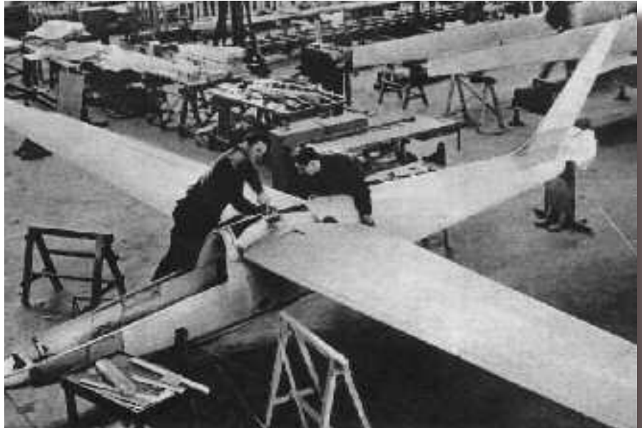
La chaîne de fabrication des Foka-4. Malgré les apparences, c'est un planeur très majoritairement en bois (plans dans la Li 117, pages 19 et 20).
